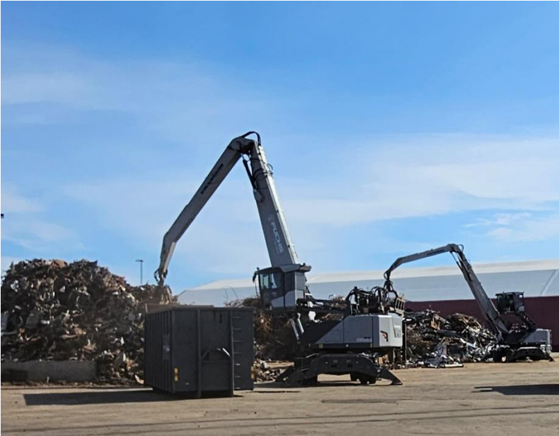
Figur 9 Hantering av material i verksamheten sker med gripklokan.
