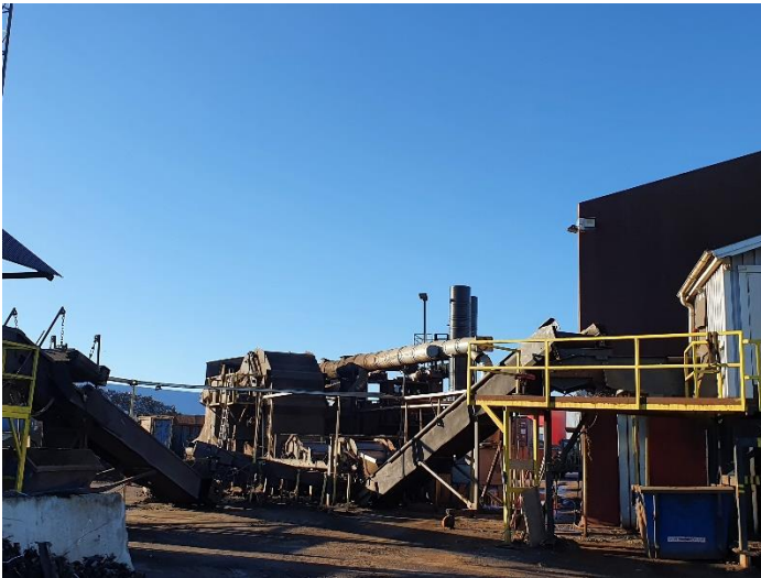
Figur 7 Hammarkvarnen med tillhörande transportband som används i den mekaniska bearbetningen.
